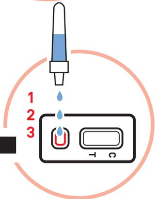
Wichtig: Die Testkassette reagiert nach dem Auftropfen der Testflüssigkeit sensibel auf Bewegung. Um das Testergebnis nicht zu verfälschen, darf sie daher nicht gedreht, geschüttelt oder bspw. von einem Raum in den anderen getragen werden.
